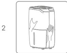
Reinigen Sie das Gehäuse mit einem weichen, trockenen Tuch. Wenn das Gerät sehr schmutzig ist, verwenden Sie ein schonendes Reinigungsmittel. Wischen Sie den Luftentfeuchter mit einem leicht feuchten Tuch ab. Sprühen Sie niemals Wasser auf das Gerät.
