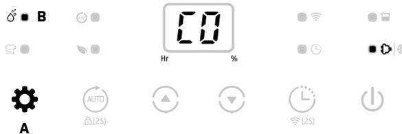
Drücken Sie die Modustaste, um den manuellen Modus zu wählen. Das Gerät läuft standardmäßig mit kontinuierlicher Entfeuchtung (B) und niedriger Lüftergeschwindigkeit.
