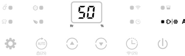
Wenn die Umgebungstemperatur zu niedrig ist, wechselt der Luftentfeuchter in den Abtaumodus. Das Gerät läuft dabei mit hoher Lüftergeschwindigkeit, ohne zu entfeuchten.
