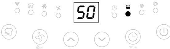
Das Gerät wechselt in den Standby-Modus, wenn der Wassertank voll oder wenn der Wassertank nicht richtig installiert ist. Nach dem Entleeren des Tanks oder der ordnungsgemäßen Installation des Wassertanks wechselt das Gerät in den vorherigen Modus.
