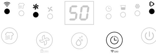
Drücken Sie 2 Sekunden lang den Timerbutton, um die WiFi-Funktion zu aktivieren und geben Sie den Verteilernetzwerkmodus ein. Während der Netzwerkconfiguration blinkt die WiFi-Anzeige schnell, nachdem eine Verbindung mit dem WiFi hergestellt ist, leuchtet die Anzeige dauerhaft.
