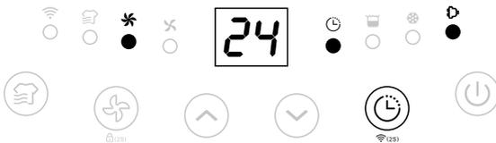
Drücken Sie die Timer-Taste, um Ihre bevorzugte Timer-Stunde von 00-24-00 für die automatische Abschalteneinstellung durch jedes Drücken auszuwählen.
