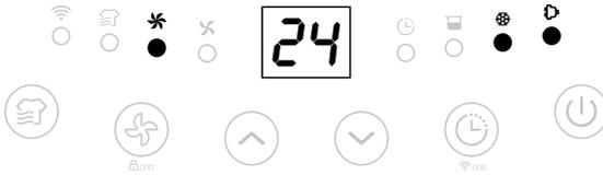
Wenn die Umgebungstemperatur zu niedrig ist, wechselt der Luftentfeuchter in den Abtaumodus. Das Gerät läuft dabei mit hoher Lüfterdrehzahl, ohne zu entfeuchten.
