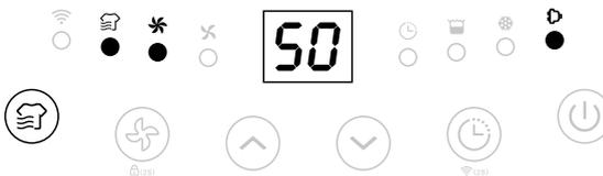
Drücken Sie die Modus-Taste einmal, um den Wäschetrocknungsmodus auszuwählen. Das Gerät läuft in kontinuierlicher Entfeuchtung mit hoher Lüfterdrehzahl für 6 Stunden und schaltet dann automatisch ab.
