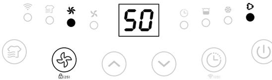
Drücken Sie die Lüfterdrehzahlstaste, um Ihre bevorzugte Lüfterdrehzahleinstellung von niedrig und hoch auszuwählen, um die unterschiedlichen Nutzungsanforderungen zu erfüllen.
