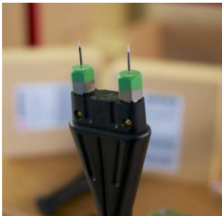
Abbildung 4-3 Holzfaserdämmstoff Elektrode auf Elektrode M 20
