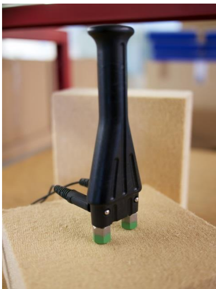
Abbildung 4-4 Holzfaserdämmstoff Elektrode M20
