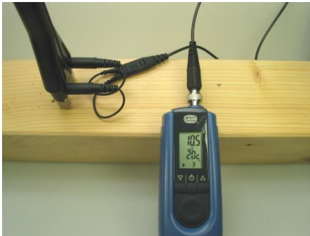
Abbildung 4-1 Messung quer zur Faserrichtung mit M 20
